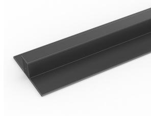
Rail d'accrochage en deux parties qui peut être soudé ensemble pour joindre les rouleaux de bout en bout ou d'un côté à l'autre pour couvrir de grandes surfaces. Nous recommandons un tube de pâte à souder à froid pour 10 m de profilé. Livré en gris foncé. Dimension: 10,5 mm x 2,5 m
